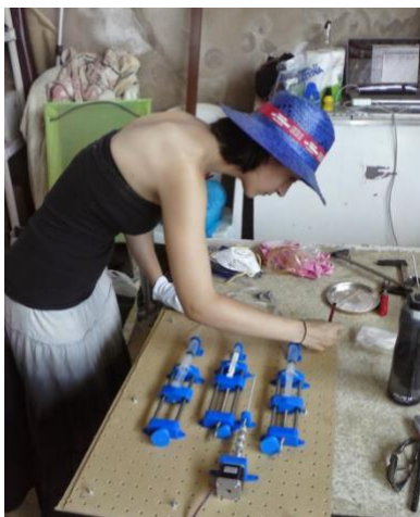
Fotografía 3. Montaje del prototipo funcional de impresora 3D para piel humana - Nieves Cubo y Emilio Cubo =)
